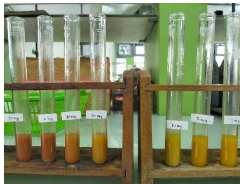
Gambar 3. Hasil pengujian boraks pada mie basah menggunakan ekstrak kunyit
